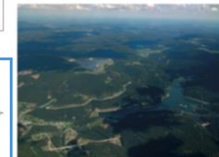
Abb. 4: Im Thüringer Schiefergebirge liegen, ist das Pumpspeicherkraftwerk Goldsthal mit einer Leistung von 1.000 Megawatt die leistungstärkste Wasserkraftanlage Deutschlands. Auf der Aufnahme sind das Ober- und Unterbecken zu erkennen. Quelle: © Andreas Metzner, Pumpspeicherkraftwerk Goldsthal Luftaufnahme (2020), via Wikimedia Commons, CC BY-SA 4.0.
