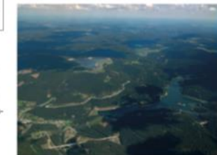
Abb. 4: Im Thüringer Schiefergebirge liegen, ist das Pumpenspeicherwerk Goldsthal mit einer Leistung von 1.060 Megawatt die leistungstärkste Wasserkraftanlage Deutschlands. Auf der Aufnahme sind das Ober- und Unterbecken zu erkennen. Quelle: © Andreas Metzner, Pumpenspeicherwerk Goldsthal Luftaufnahme (2020), via Wikimedia Commons, CC BY-SA 4.0.
