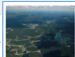
Abb. 4: Im Thüringer Schiefergebirge liegen, ist das Pumpspeicherkraftwerk Goldsthal mit einer Leistung von 1.000 Megawatt die leistungstärkste Wasserkraftanlage Deutschlands. Auf der Aufnahme sind das Ober- und Unterbecken zu erkennen. Quelle: © Andreas Metzmaier, Pumpspeicherkraftwerk Goldsthal Luftaufnahme (2020), via Wikimedia Commons, CC BY-SA 4.0.
