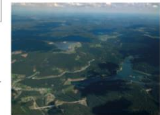
Abb. 4: Im Thüringer Schiefergebirge liegen, ist das Pumpspeicherkraftwerk Goldsthal mit einer Leistung von 1.060 Megawatt die leistungstärkste Wasserkraftanlage Deutschlands. Auf der Aufnahme sind das Ober- und Unterbecken zu erkennen. Quelle: © Andreas Metzner, Pumpspeicherkraftwerk Goldsthal Luftaufnahme (2020), via Wikimedia Commons, CC BY-SA 4.0.
